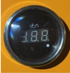
Muestra la temperatura del aceite hidráulico cuando la temperatura alcanza 80 °C. Activar la temperatura del radiador para enfriar el aceite hidráulico.
