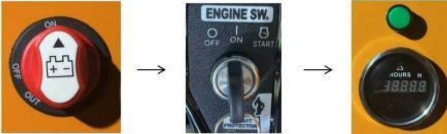
Gire el interruptor de encendido a la posición ON, luego gire la llave del motor a la posición ON, la luz indicadora se encenderá y el temporizador comenzará a registrar el tiempo total de trabajo.
