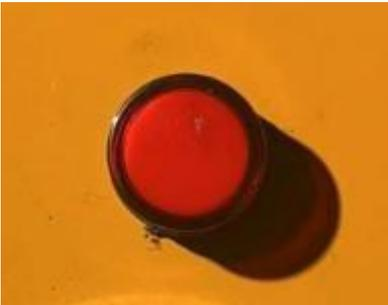
Cuando la temperatura del aceite alcanza 80°C, el ventilador del radiador se enciende automáticamente, y la luz indicadora se ilumina, indicando que el ventilador del radiador está funcionando.
