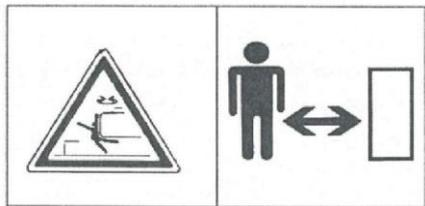
No coloque las manos, los pies u otras partes del cuerpo entre las orugas. Cuando la excavadora esté en el estado de puesta en marcha funcionamiento, está estrictamente prohibido llevar a otras personas dentro del funcionamiento, que estén en el radio de movimiento de la máquina y apilar objetos que obstruyan la excavadora. Para evitar causar magulladuras y aglomeración.
