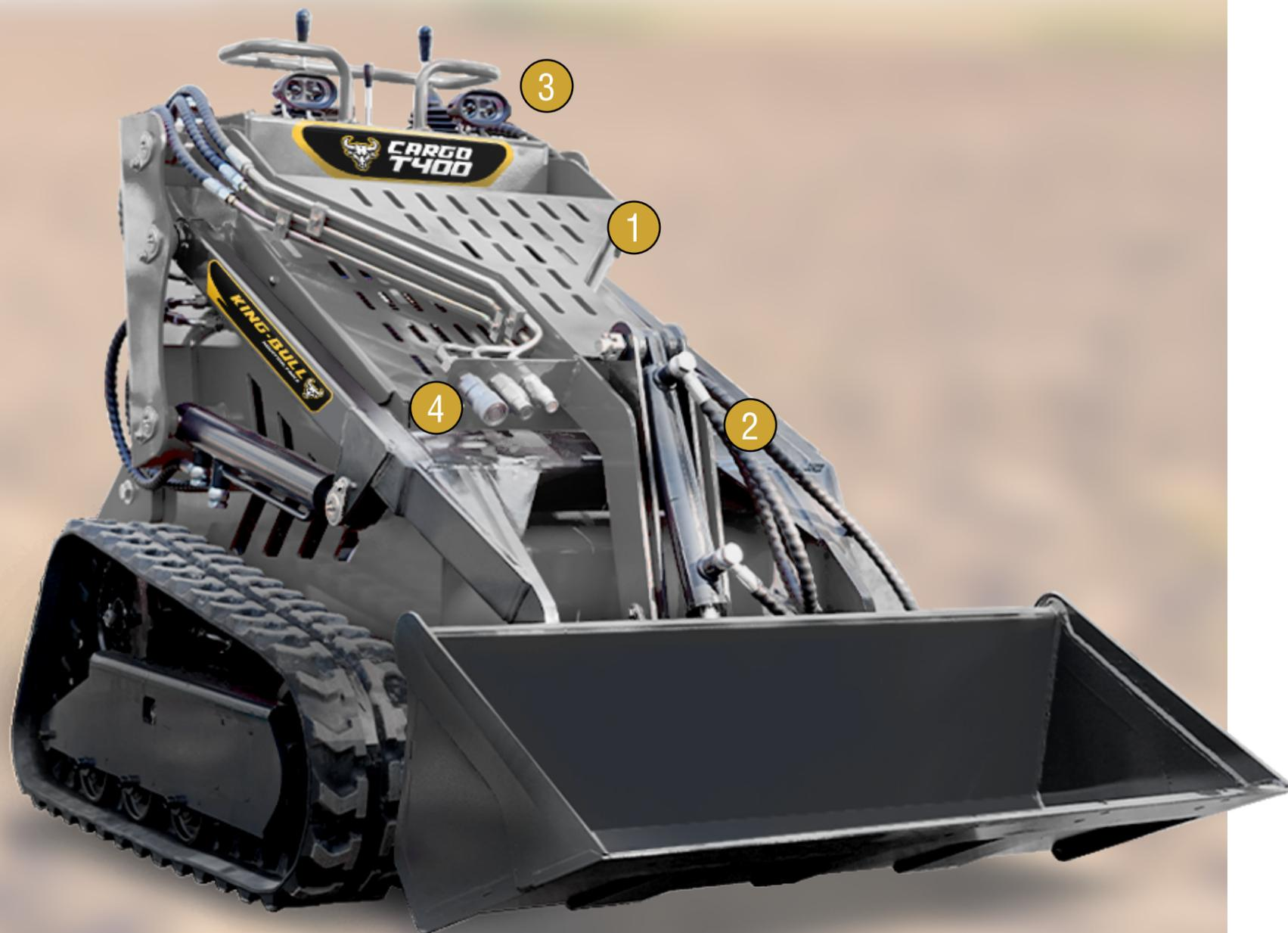
El Radiador de Aceite Hidráulico de 150L, con Gran Capacidad de Disipación de calor Protege el Motor de los daños causados por el Sobrecalentamiento. Además, puede reducir el tiempo de calentamiento del aceite hidráulico durante la operación y extender las horas de trabajo.
